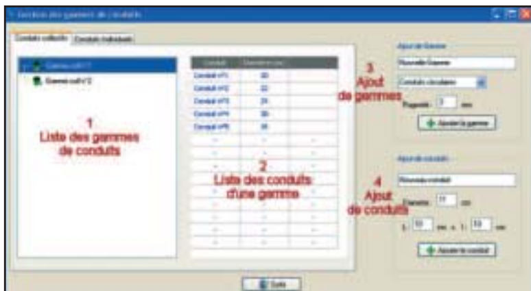
Figure 8.9 : gestion des gammes de conduits
