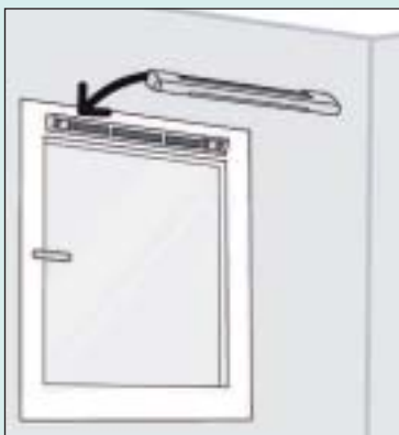
Figure 9.2 : exemple de fixation d'une entrée d'air sur fenêtre
